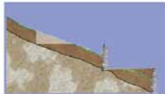
Il terreno di scavo è utilizzato come riempimento per il terrazzamento
