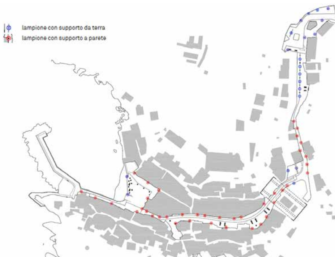
Figura 31. Schema di progetto per l'illuminazione pubblica
