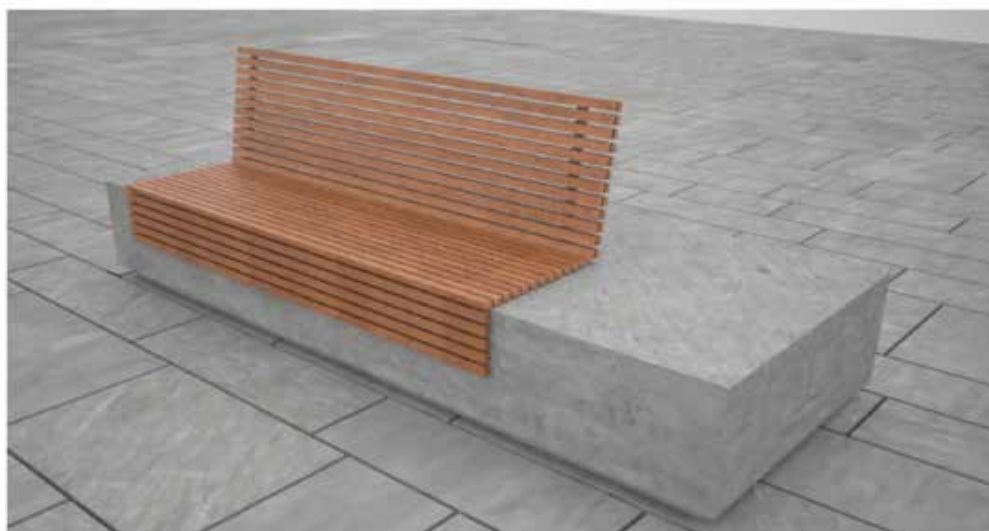
Figura 33. Render di progetto delle sedute fisse realizzate con blocchi massicci di pietra arenaria dello stesso tipo di quella utilizzata per le pavimentazioni e doghe in teak.
