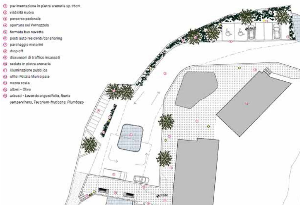
Figura 26. Progetto di risistemazione del parcheggio
